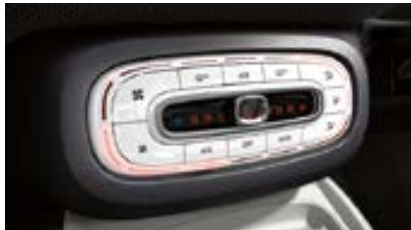
Klimatisierungsautomatik mit automatischer Temperaturregelung [I01]
