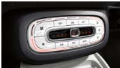
Klimatisierungsautomatik mit automatischer Temperaturregelung [I01]
