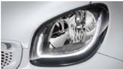
H4-Halogencheinwerfer mit Welcome- Funktion und integriertem Tagfahrlicht in LED-Lichtleiter-Technik [K32]
