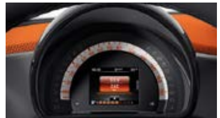
Kombiinstrument mit farbigem 8,9 cm (3,5") Display in TFT-Technologie und Bordcomputer [K36]
